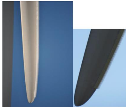
Photographies de peignes montés sur des pales d'une éolienne (source Vestas)
